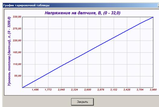
Рисунок 55 — График тарировочной таблицы
