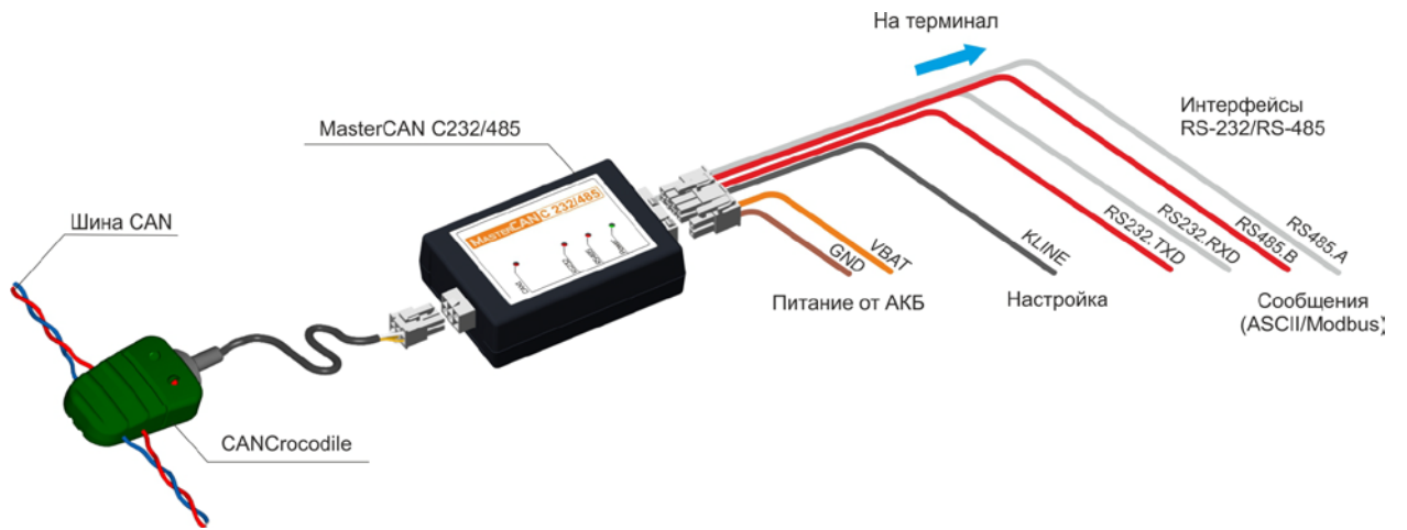
Рисунок 16 — Подключение MasterCAN С 232/485 к шине CAN
