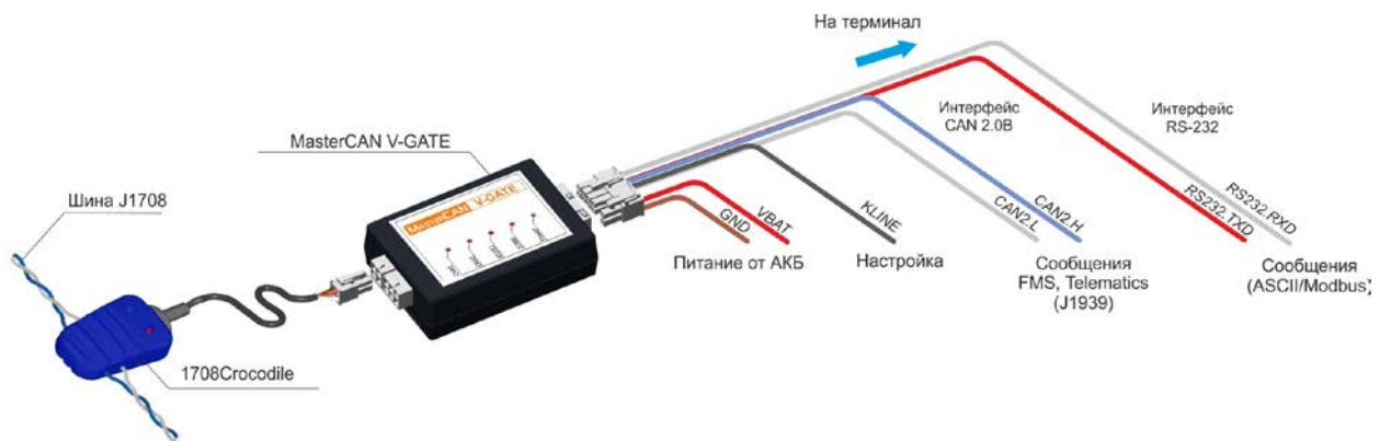
Рисунок 18 — Подключение MasterCAN V-GATE к шине J1708
