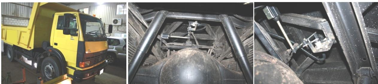
б) упругий элемент расположен перпендикулярно поворотному рычагу датчика
