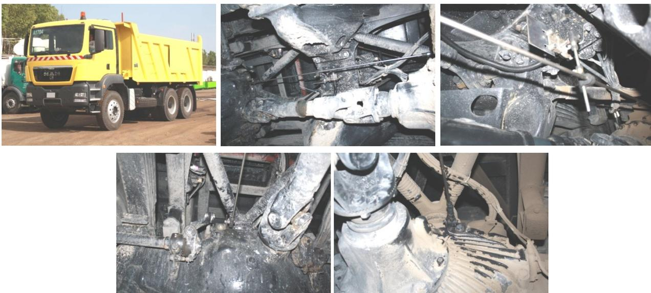
*а) крепление датчика к раме ТС при помощи болтов*
