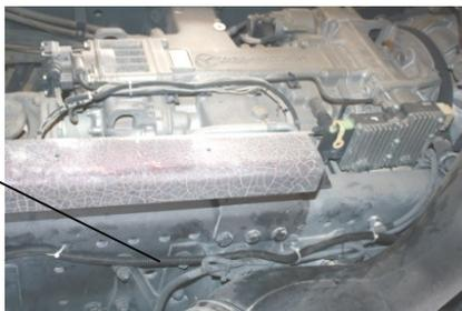
Рисунок 16 — Укладка сигнального кабеля DP
